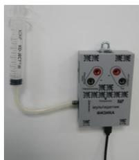
При соединении датчика давления со шприцом Жане силиконовой трубкой образуется замкнутый объём. При перемещении поршня внутрь на экране отражаются изменения давления. По шкале шприца всё время объём менялся на фиксированное значение. Изменение давления отражается на графике.
